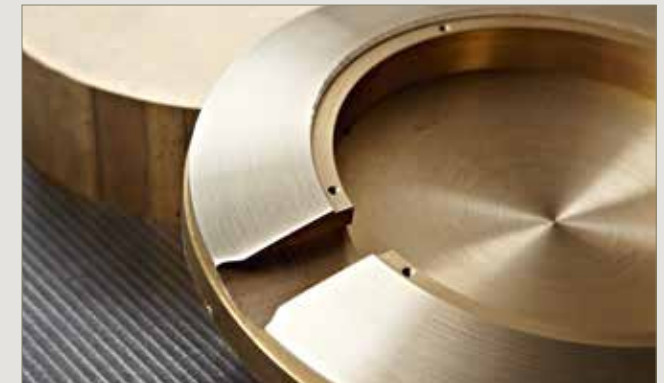
Die Pendellinse wird aus einem massivem Stück Messing gedreht und gefräst. The pendulum bob is milled and turned from a single piece of brass.
