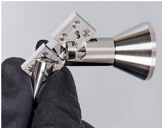
Schieben Sie anschließend das Schutzrohr wieder auf den Pendelgalgen. Durch das einseitig angebrachte Barometerinstrument wird das Pendel geringfügig aus der Mittellage gedrückt. Richten Sie durch Drehen der seitlichen Rändelmutter die Pendelskala so aus, dass die Spitze des Pendels exakt auf die »0« zeigt.
