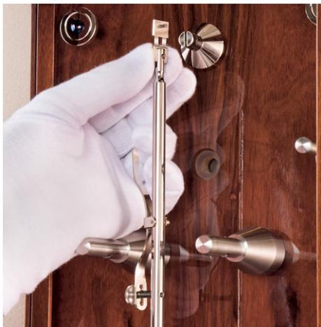
Die Pendelspitze sollte nun exakt auf den »0-Punkt« der Pendelskala zeigen. In dieser Position ist die Gangsymmetrie vom Werk aus eingestellt.
