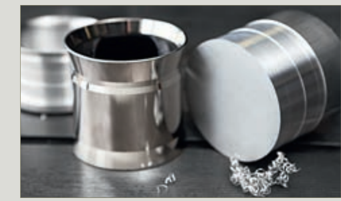
Das hochwertige Herzstück der Uhrenbeweger wird aus Gewichtsgründen aus Aluminium gedreht. To keep the weight down, the high-quality centrepiece of the watch winder is milled from aluminium.
