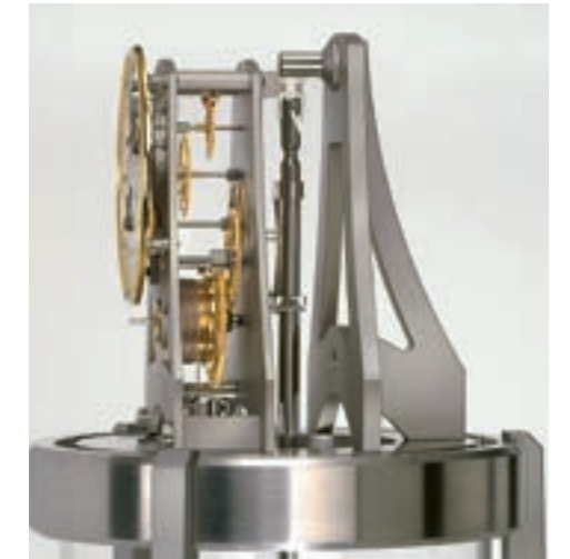
Die Columnna Temporis bietet einen 360°-Blick auf ihr Präzisions Uhrwerk, das außer dem transparenten Mineralglas durch kein Gehäuse verdeckt ist. The Columnna Temporis offers a 360° view of its precision movement, which is not hidden by any case but is covered by transparent mineral glass.
